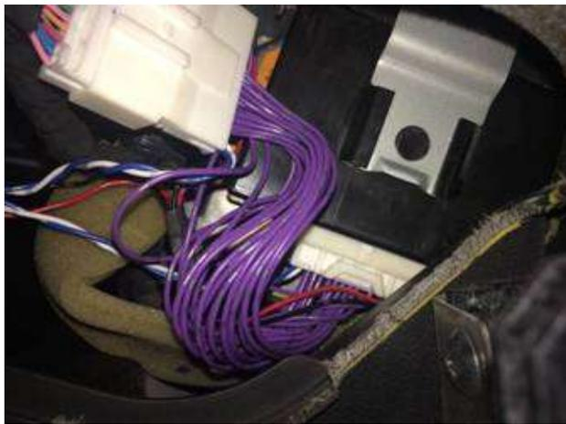
②ハンドル右下にあるタイヤ空気圧モニター用のECUカプラーを外してECUと車両配線の間
